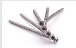
ダンパーが緊結されている柱や梁などから離れないよう、長さは90mmとしています。また、高いねじ山と低いねじ山の二条ネジとし、先端は木割れ防止のカット加工がなされています。
