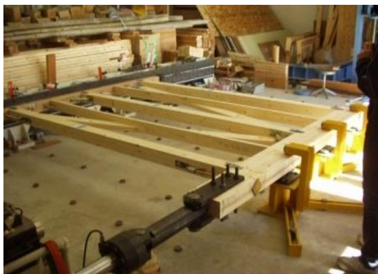
軸組+筋かい+ダンパー
