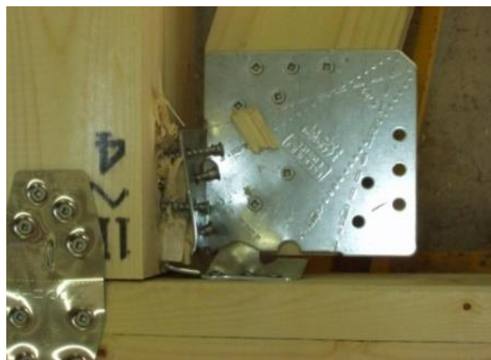
軸組+筋かい(ダンパーなし) ※繰返しの揺れで引き抜かれた筋かい金物
