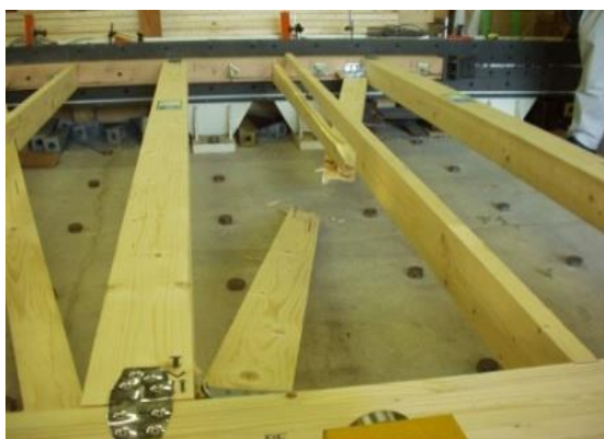
軸組+筋かい(ダンパーなし) ※繰返しの揺れで破断した筋かい
