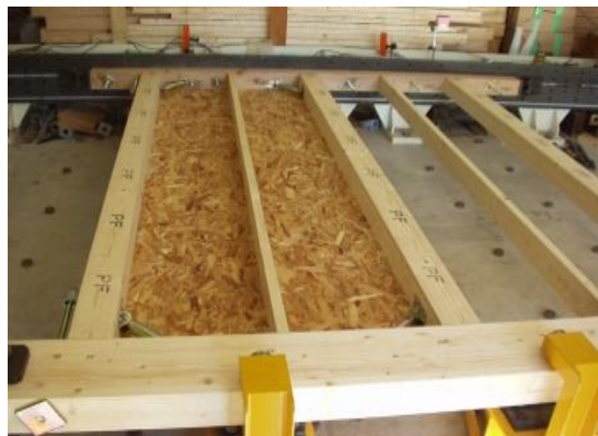
軸組+構造用パネル+ダンパー
