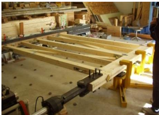
軸組+筋かい+ダンパー
