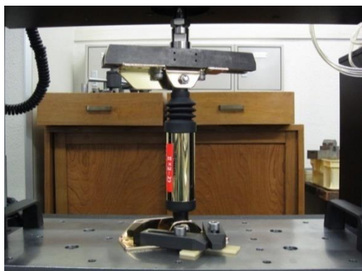
中立位置より±10mm変位させたときの荷重を測定
